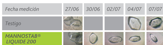
Figura 1: observación microscópica de la evolución de cristales de bitartrato de potasio colocados a -4°C en una solución que contiene o no MANNOSTAB® LIQUIDE 200.
