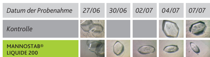
Abbildung 1: Mikroskopische Beobachtung der Entwicklung von Kaliumhydrogentartrat-Kristallen bei einer Temperatur von -4°C in einer Lösung, in der MANNOSTAB® LIQUIDE 200 jeweils enthalten und nicht enthalten ist.
